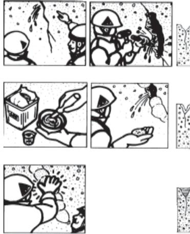
Đục bê tông hoặc đá hình chữ “V” xung quanh nơi rỉ nước. Làm sạch những mảnh vụn vỡ, tạp chất và làm sạch bề mặt bằng nước trước khi thi công Sika® Plug CN.
